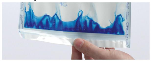
Die Siegelnaht entspricht den Vorgaben. Die Prüftinte dringt nicht durch die Siegelnaht.
