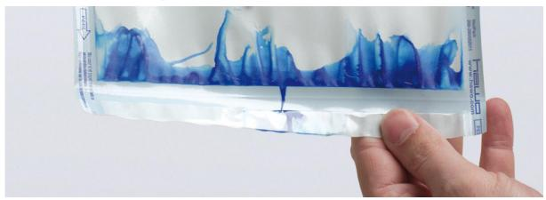
Die Siegelnaht entspricht nicht den Vorgaben. Die Prüftinte dringt durch die Siegelnaht. Das Siegelgerät muss überprüft und der Tintentest wiederholt werden.
